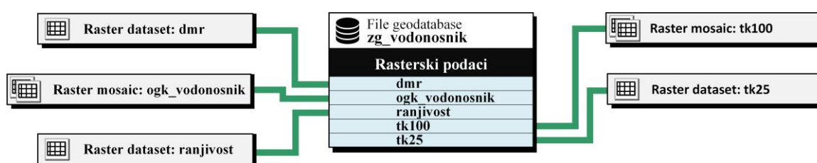
Slika 7-7. Shematski prikaz rasterskih podataka u geoprostornoj bazi podataka
